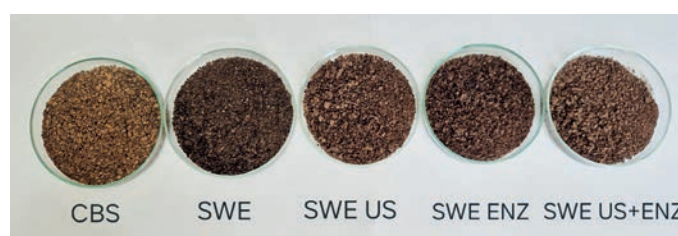
► Figura 3 Aspetto delle fibre di cacao (CBS: fibra di buccia di cacao controllo; SWE: estratto con acqua subcritica; US: ultrasuoni; ENZ: enzimi) dopo i vari trattamenti singoli e combinati
