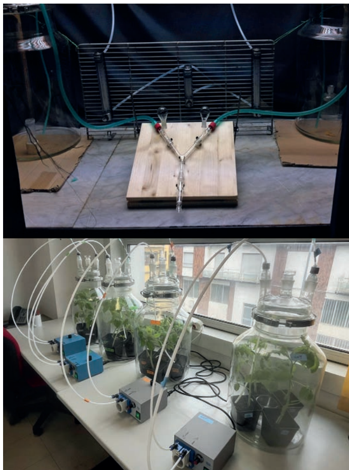
Set up (olfattometro ed air entrainment) per lo studio e la caratterizzazione di composti volatili organici utilizzabili per la difesa delle piante
