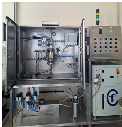
> Figura 1 Sistema di estrazione in acqua subcritica, combinabile con altri sistemi di processing
